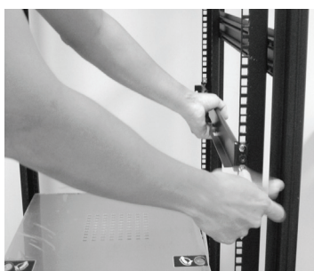
步驟1. 將滑軌鎖在機架上
