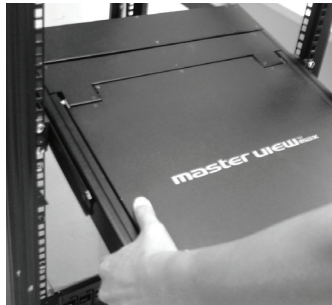
2. 將LCD KVM多電腦切換器 / LCD控制端滑入滑軌中，並固定於機架上。
