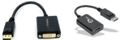
DP to DVI 액티브 어댑터(左) vs DP to HDMI 액티브 어댑터(右). 전용 영상 신호 변환 회로가 내장되어 있고 모니터와 연결을 위해 별도의 듀얼링크 DVI / HDMI 케이블이 필요하다.
