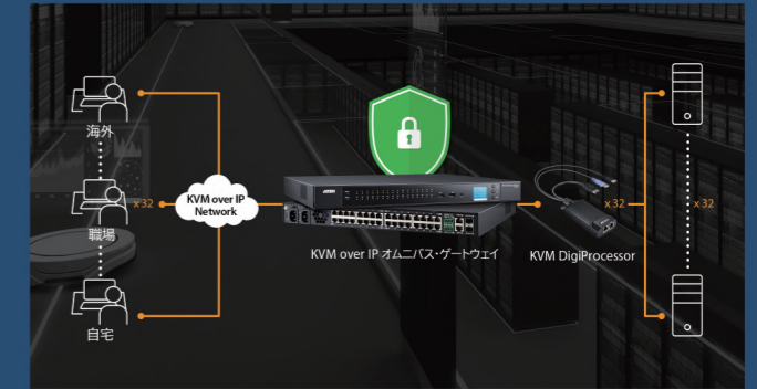
最大32名が接続サーバーにリアルタイムで同時アクセス可能
