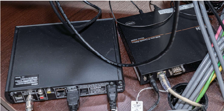
▲ テレビマスター監視室 監視対象の 4 つのソースの送出端末を IP-KVM スイッチ経由で表示。責任者 1 名が全体を監視
