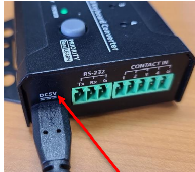
電力不足の時は ここに給電してください。
